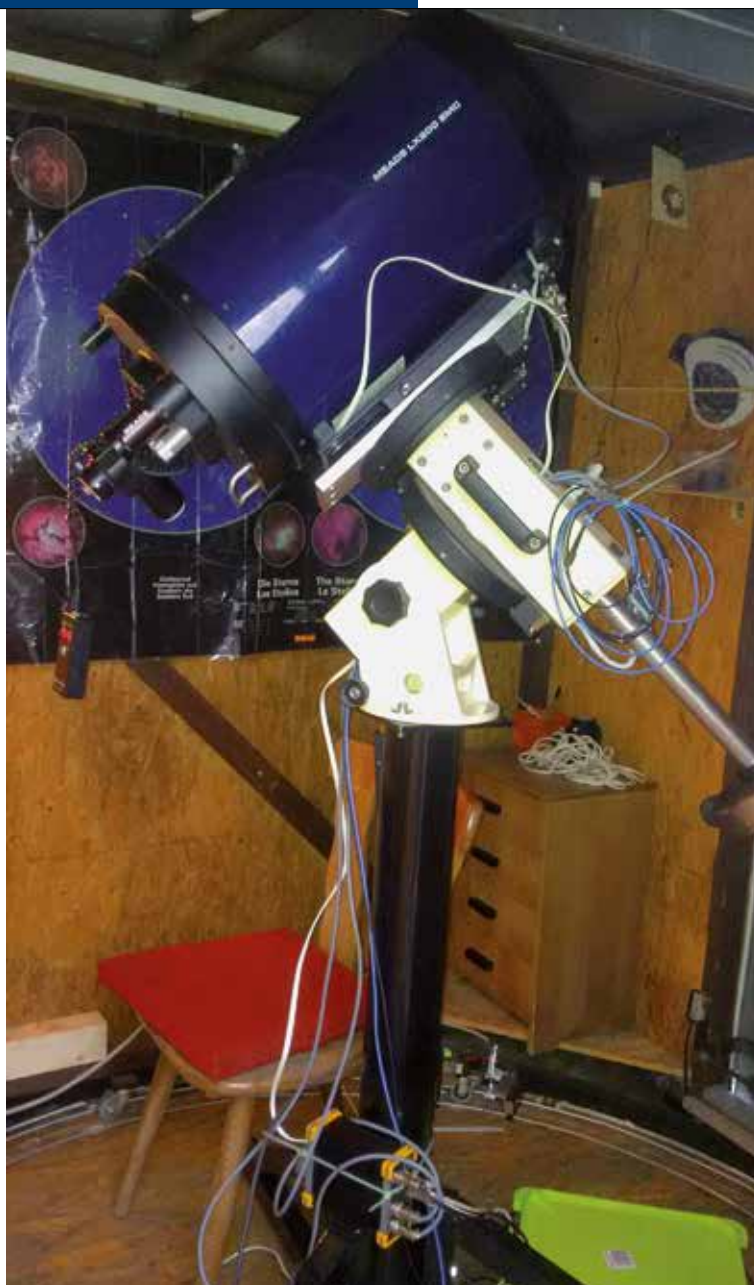
Foto des Teleskops auf der Gemini 40. Das blaue und schwarze Kabel sind die Lichtleitfasern. Unten sieht man die LF an der Säule und in der gelbgrünen Kunststoffkiste ist einiges der Netzwerktechnik untergebracht.
