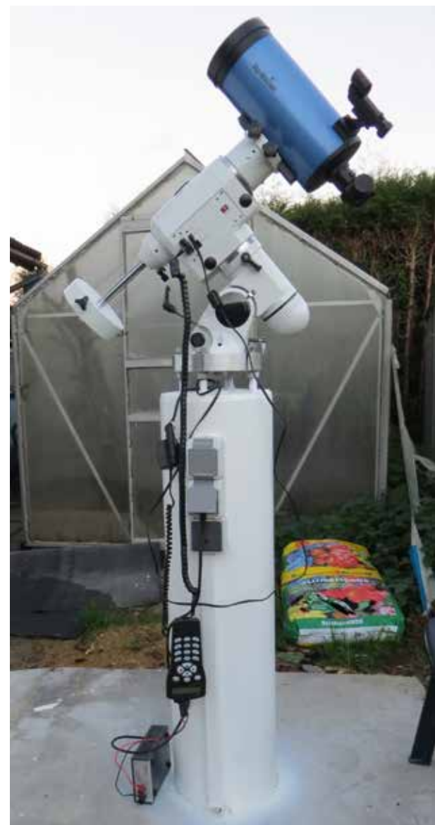
Die Betonsäule mit Adapter nach dem Guss
