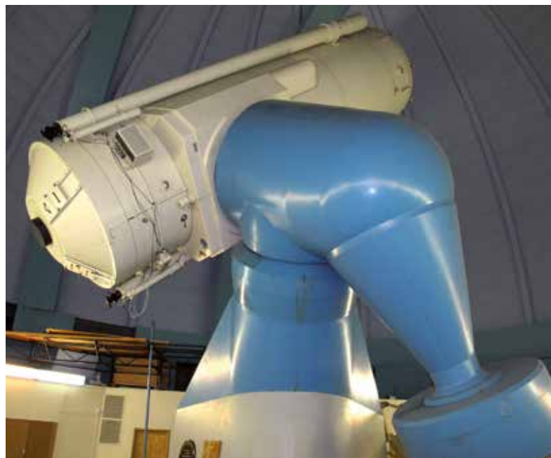
Das 2-Meter-Instrument wurde bei Carl Zeiss in Jena gefertigt und hat Ähnlichkeiten mit dem Tautenburger Teleskop.
