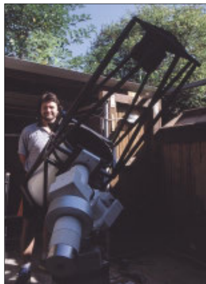
Abb. 1: Der Newton in der Gesamtansicht mit dem Carbonstangen-Tubus
