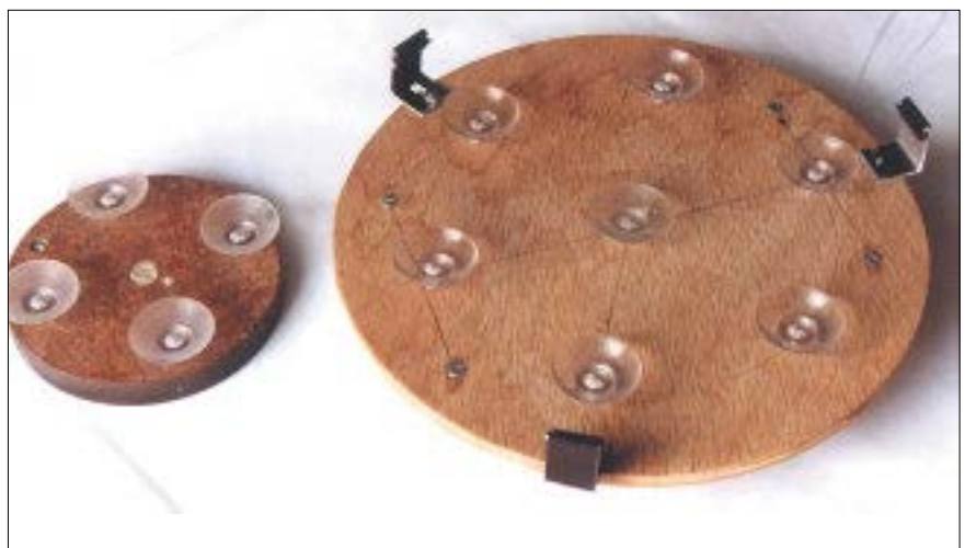
Abb. 4: Haltegriff zum Warmpressen des Polieres, links: für kleinere Polierer, rechts: für größere Polierer – mit Halteklammern am Rand
