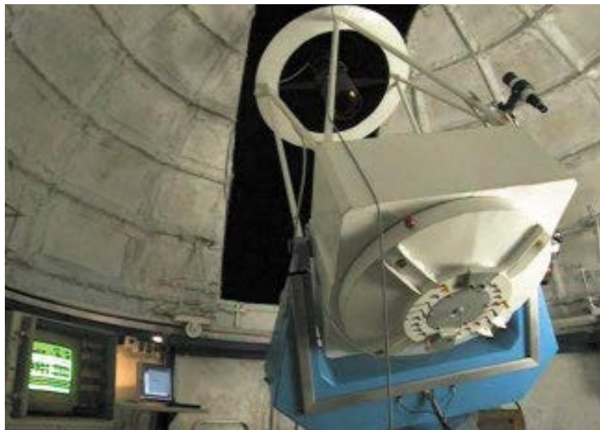
Abb. 1: Deltagraph bei Nacht Das 60 cm Teleskop im nächtlichen Einsatz, montiert in der Privatsternwarte Meyer/Obermair. Links im Bild ist das Teleskopsteuersystem (eingebaut in einem Schaltkasten) und im Hintergrund das Notebook für die CCD-Kamera zu sehen.
