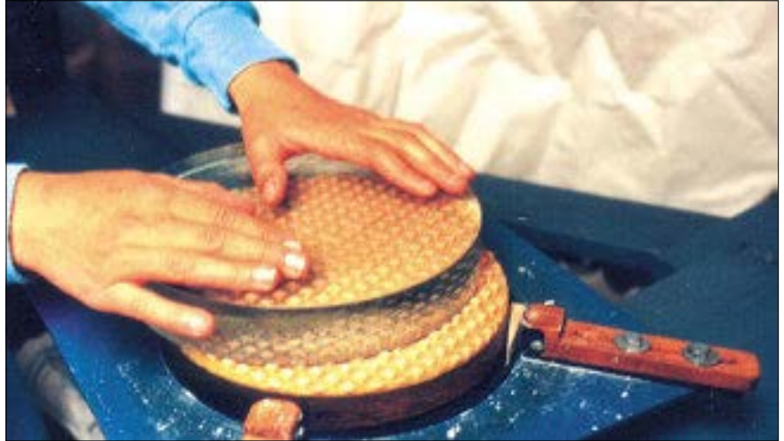
Abb. 6 (rechts): Politur eines Spiegels mit Drittelstrichen auf Gelbpech mit Polierweiß – Spiegel oben
