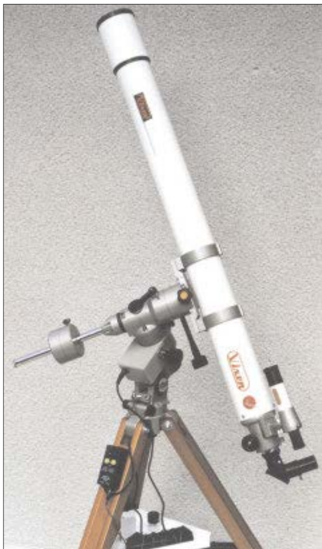
Abb. 1: Der 80/1200 mm Refraktor aus der „GP-E“ – Serie von VIXEN. Als Sonderzubehör ist der Schrittmotor in Rektaszension sowie das Steuergerät „SD 1“ installiert.
