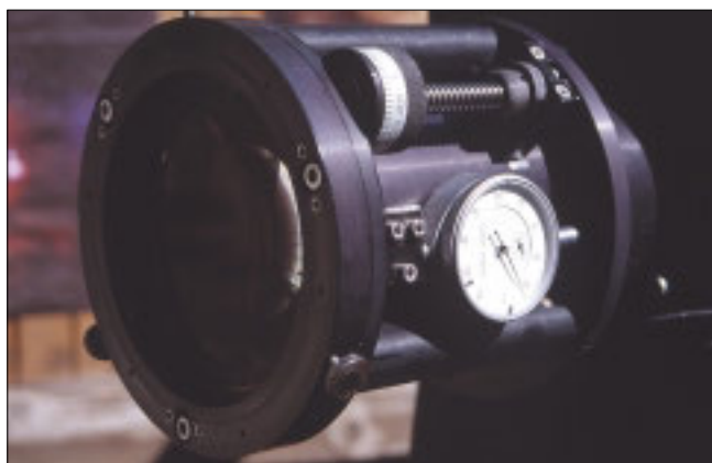
Abb. 2: Der dreilinsige Wynne-Korrektor in der seitlichen Ansicht mit der hochpräzisen Fokusmeßuhr
