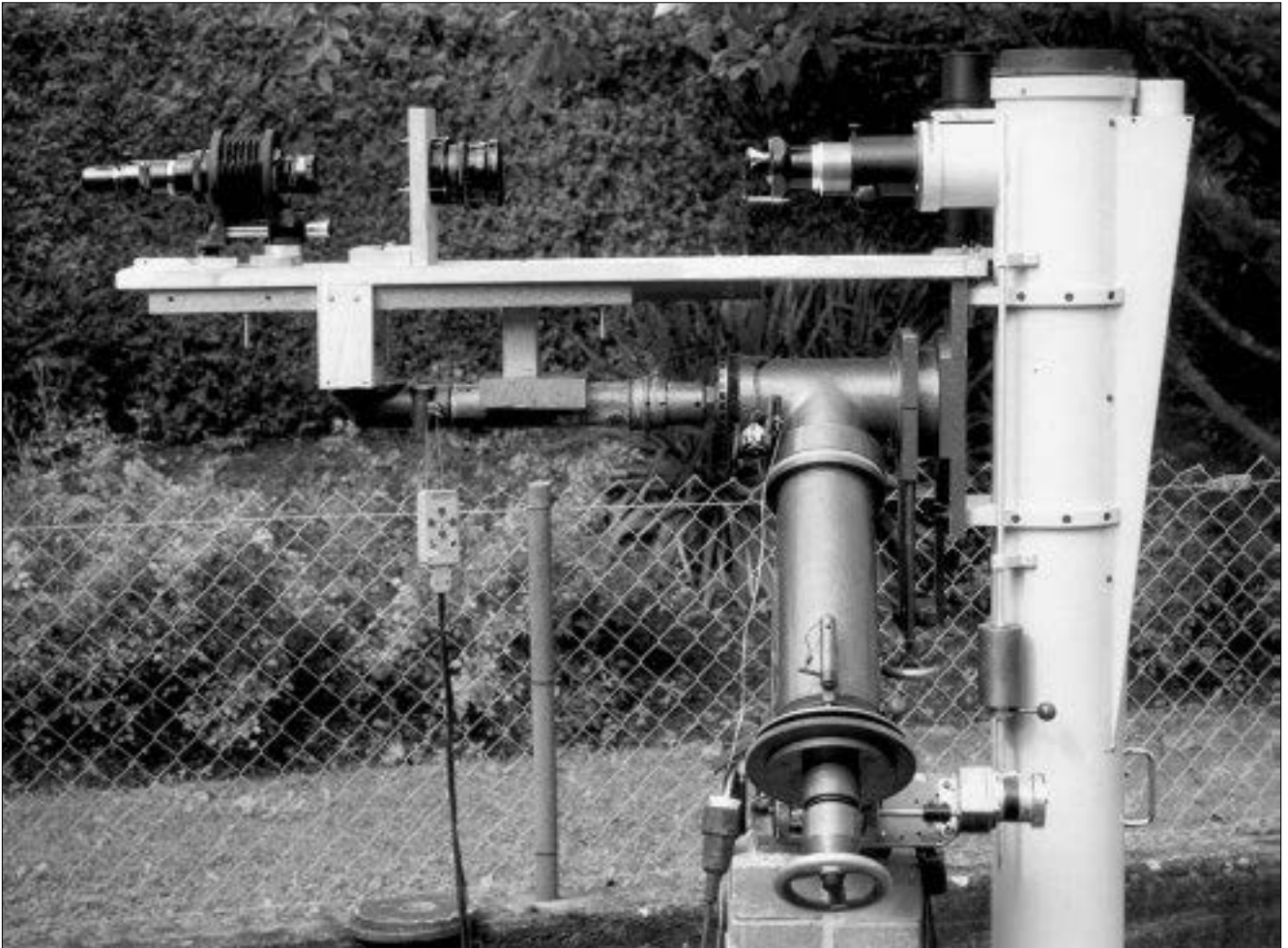
Abb. 3: Das komplette Instrument: 150 / 3000 / 3480 mm Faltrefraktor mit Unigraphen-Ansatz.
