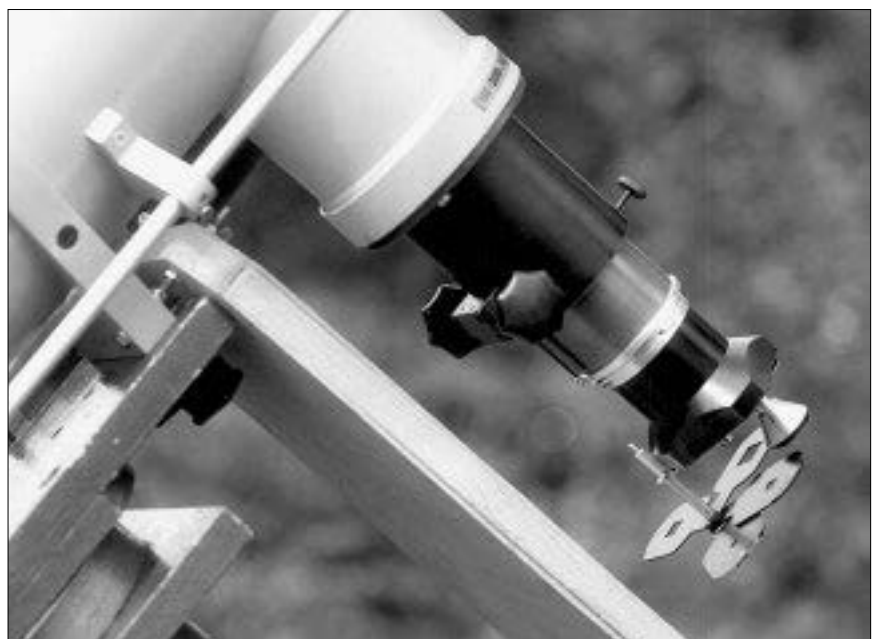
Abb. 4: Detailansicht des Kegels mit Steckblendensatz im Okularauszug (F1-Primärfokus).
