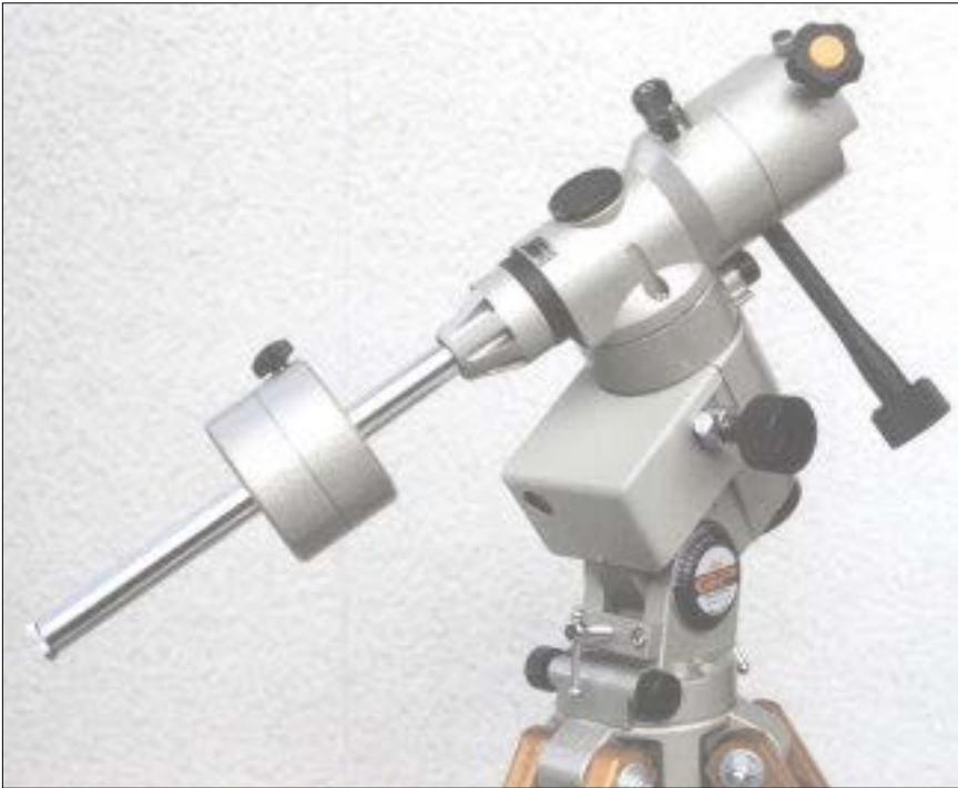
Abb. 2: Das Herzstück des Instruments – die „GP-E“ Montierung – in der Nahansicht. Sehr praxisgerecht ist die Feineinstellung für Azimut und Polhöhe ausgefallen.
