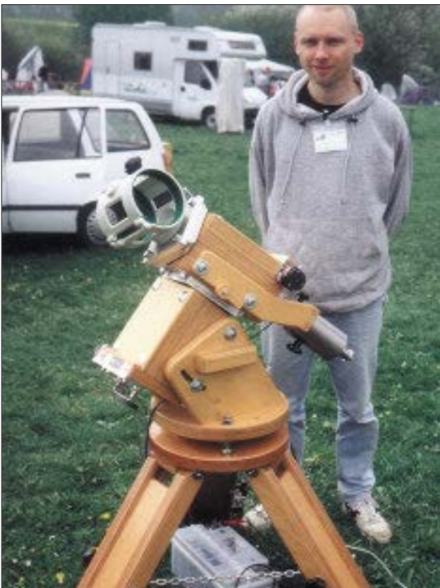
Abb. 6: Michael Koch mit seiner selbst gefertigten parallaktischen Montierung aus Holz
